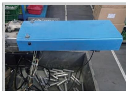
● 設備可動部へのカバー設置の徹底
