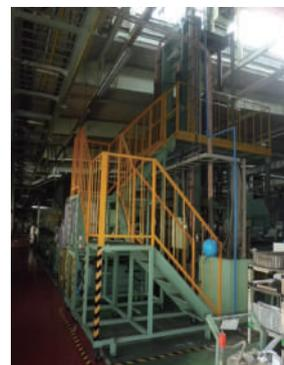
垂直梯子を廃止し階段を設置した。工具を持ち、両手が塞がっていても安全に設備上部と行き来出来る様になった。
