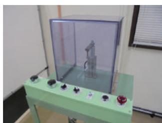
生産設備には、各種のスイッチが使用されており、目的・用途等によりスイッチの形状を変えているが、それを周知・理解させるため、新たに体感機を設置しました。
